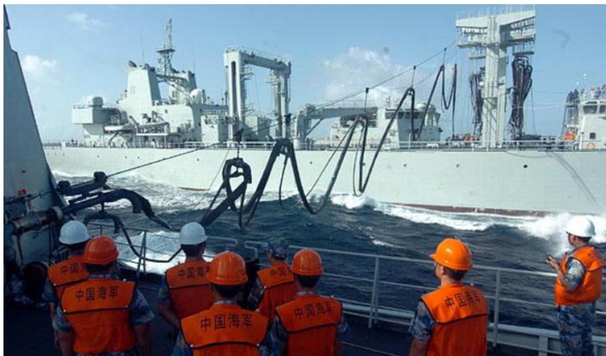
圖 4.7 中共「千島湖」號綜合補給艦向「舟山」號導彈護衛艦進行航行中橫向補給作業
